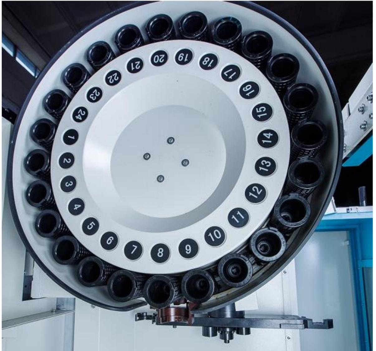
Рисунок 3–24-позиционная система смены инструмента
