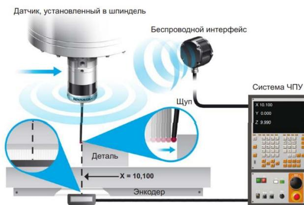
Рисунок 5 - Схема работы датчика
